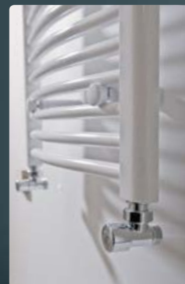
DRL designkranenset Ovus haaks in handbediende uitvoering (DRL art.nr. 550012) is thermostatisch voorbereid M 30x1,5. Bijbehorende koppelsset 14/2, 16/2 of 15 mm met chromen rozetten en thermostatisch regelelement apart te bestellen.
