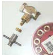
6. Neue O-Ring-Kammer aufsetzen und mit Nutenschlüssel kräftig festziehen.
