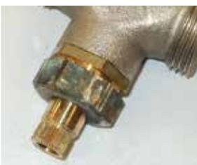
6. O-Ring-Führungsmutter mäßig anziehen und Handrad aufsetzen.
