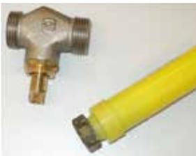
3. Spindel und O-Ring-Führungsmutter reinigen (Fräser der O-Ring-Box verwenden). Scharfkantige Gegenstände beschädigen die Dichtflächen!
