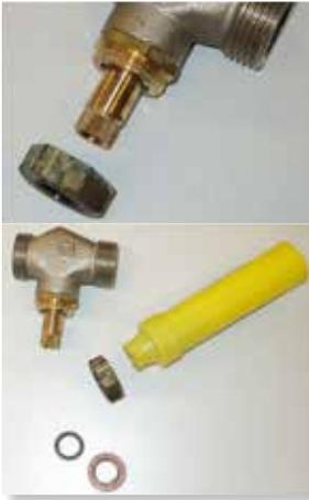
2. O-Ring-Führungsmutter lösen und O-Ring mit Klingeritdichtung entfernen (Oberteil gegenhalten).
