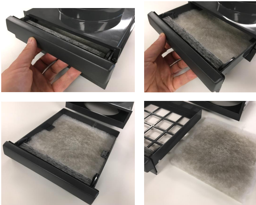
Figuur 4.1 Bovenstaande foto's geven aan hoe u de filterbox open maakt en het filter uit de cassette haalt. Het terugplaatsen gaat in de omgekeerde volgorde
