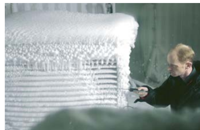
Testteams laten de units onder extreme weersomstandigheden draaien in de klimaatkamer.
