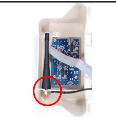
Montieren Sie das Antennenkabel zwischen den zwei beiliegenden Unterlegscheiben seitlich an der der RF-Antenne!!!
