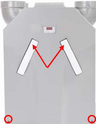
Entfernen Sie zunächst die beiden Filter und danach die beiden Schrauben am unteren Rand der Platte. Dann Frontplatte nach oben schieben.
