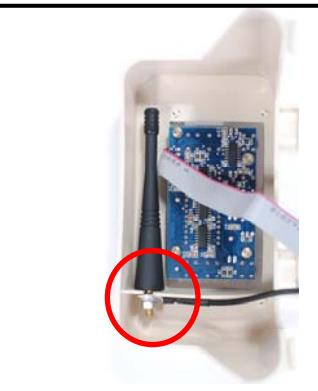
Montez le câble de l'antenne du côté de l'antenne entre les deux rondelles plates fournies à la livraison ! Ensuite, montez l'écrou et la rondelle éventail livrés avec l'ensemble sur l'antenne.
