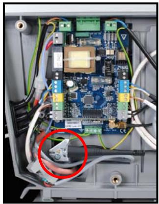
Montieren Sie den Bügel mit der beiliegenden Schraube.
